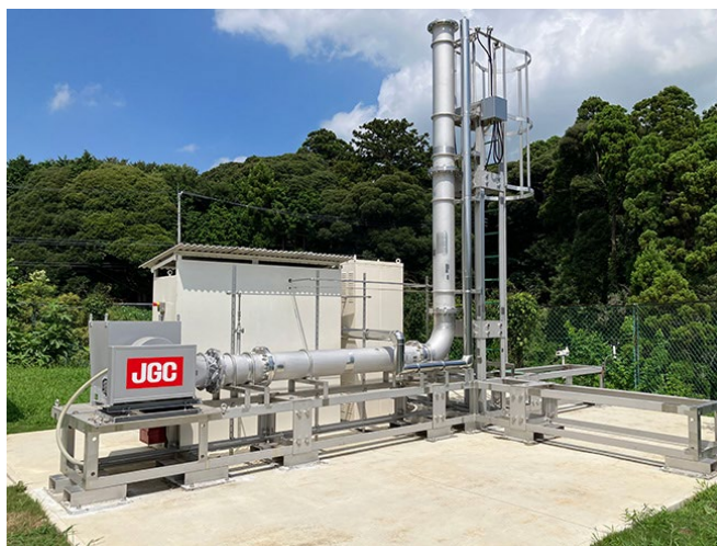
日揮 HD 技術研究所に建設したメタン排出計測技術評価設備
