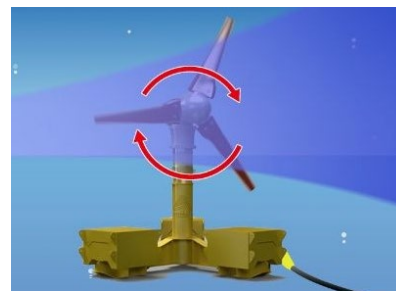
潮の運動エネルギーを使い、ブレードを回して発電する（出所：九電みらいエナジー）
